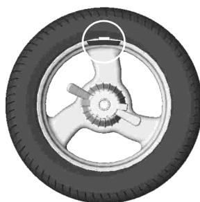
Рисунок 6.3 – Груз установлен в положение «12 часов»
